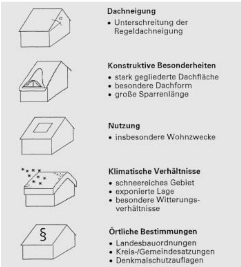
Abb. 7 – Erhöhte Anforderungen bedingen den Einbau von Zusatzmaßnahmen, die entweder die Regensicherheit weitergehend gewährleisten oder im Extremfall eine wasserdichte Konstruktion ergeben.
