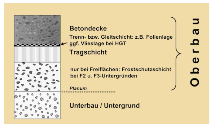
Bild 2: Aufbau eines Betonbodens
